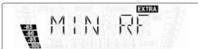
Ejemplo 2: nivel RF mínimo -85 dB.
